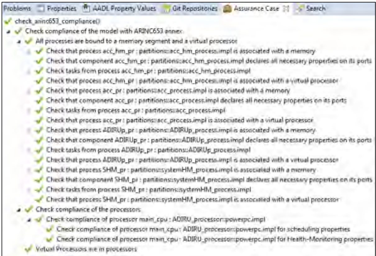
Figure 2.5 Validation de la conformité du modèle de Hugues et Delange aux exigences de l'annexe ARINC 653
