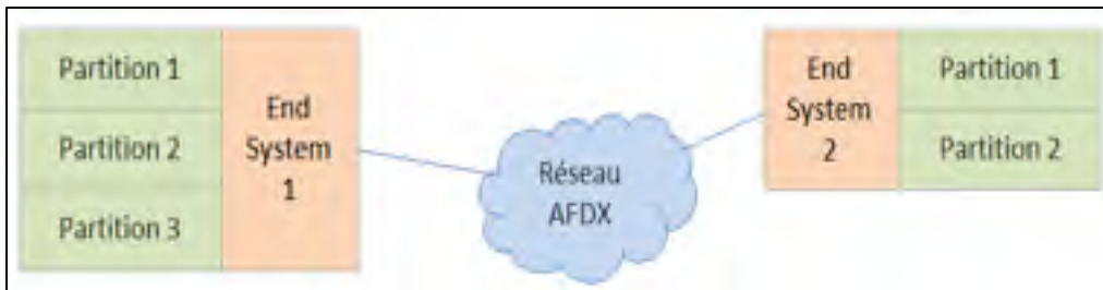
Figure 3.1 End Systems du réseau AFDX
