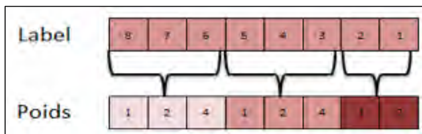
Figure 3.18 Poids des bits du label d'un mot ARINC 429
