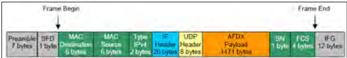
Figure 3.7 Structure détaillée d'une trame AFDX. Figure extraite de (An, D. et al. , 2015)
